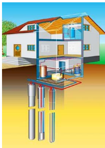
Slika 9: Izvedba sa dubinskom sondom [9]
