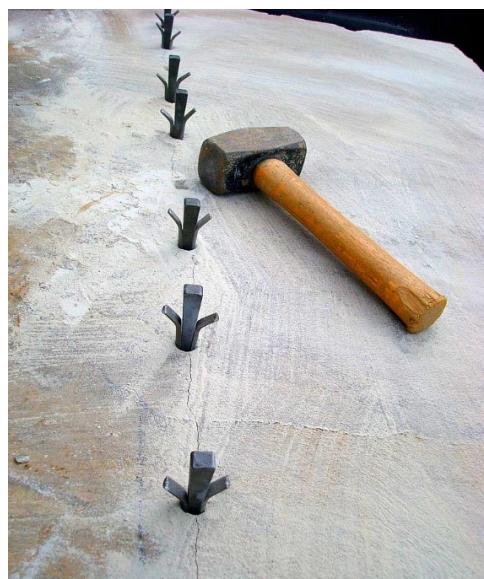
Slika 10 – Primjer korištenja tehnike klina i pera za izdvajanje kamenih blokova ( https://en.wikipedia.org/wiki/Plug_and_feather#/media/File:Plug_and_feathers_001.jpg , 3. 6. 2020.)
