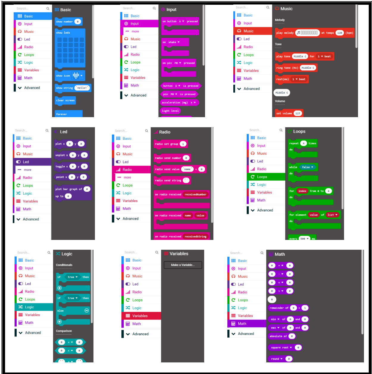
Slika 14. Grupe naredbi za BBC micro:bit uređaj
