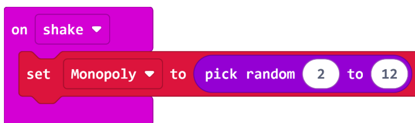
Slika 64. Naredba on shake i varijabla Monopoly u koju se sprema vrijednost nasumičnog broja
