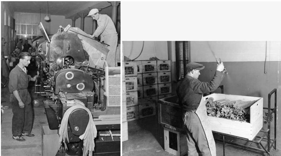
Slika 1.: Prikaz korištenja automatskog stroja za izradu cigareta u TDZ, sredina 20. st.
