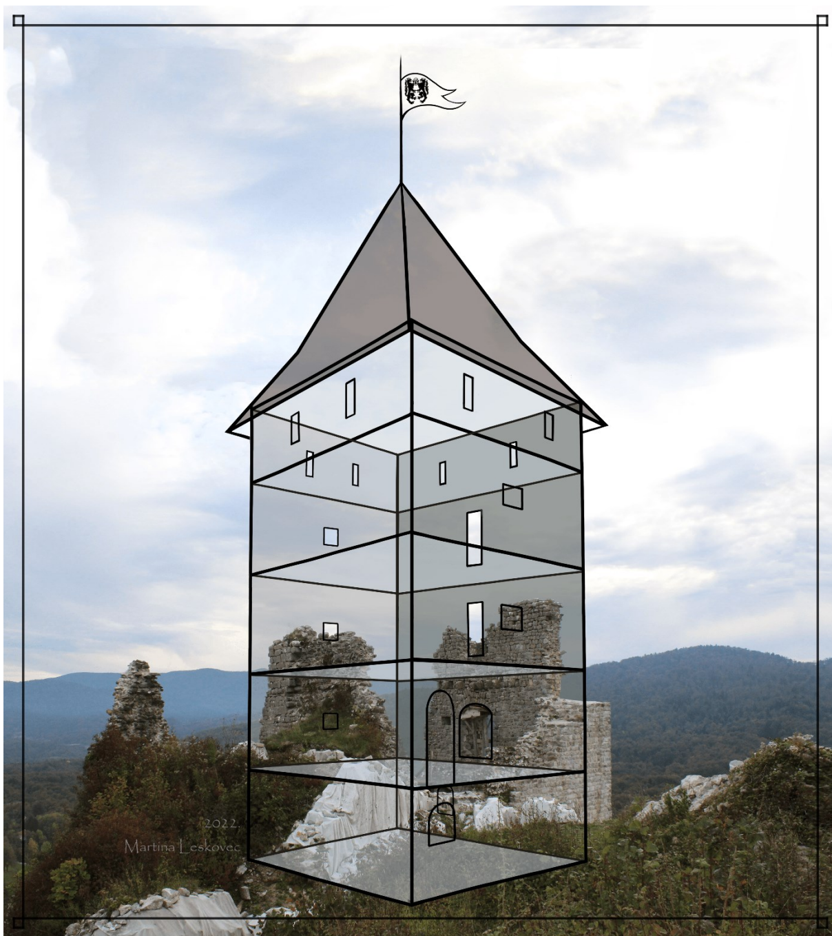
Sl. 5a. Pretpostavljena konstrukcija branič-kule superpozicionirana na fotografiju arheoloških ostataka 31 (Izradila: Martina Leskovec)
