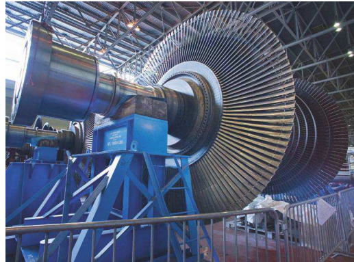
Slika 1: Turbina koju pokreće nastala para, te vrtnjom lopatica turbine nastaje električna energija [3].
