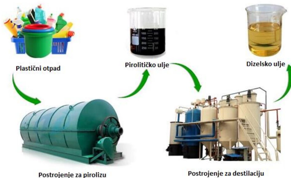
Slika 9. Proces proizvodnje dizelskog ulja iz otpadne plastike 45
