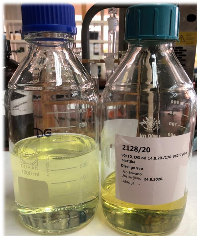
Slika 18. Čisto dizelsko gorivo (lijevo) i mješavina dizelskog goriva i pirolitičkog ulja iz plastike u omjeru 90/10, ED+10% PU (desno)
