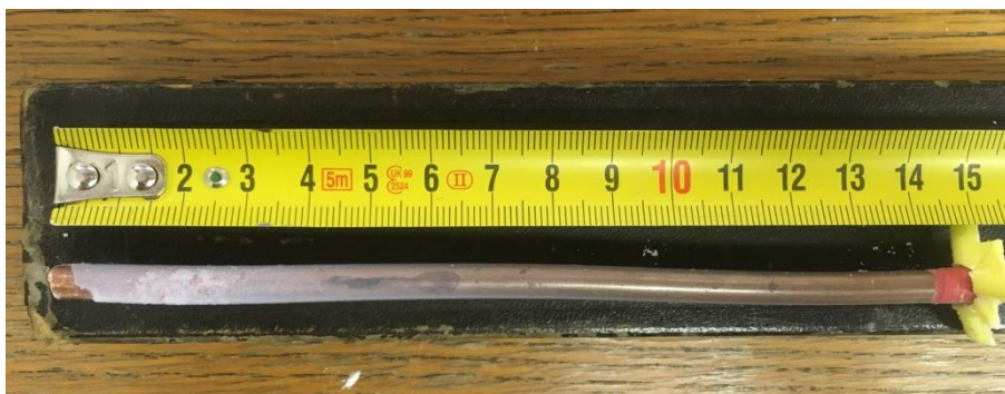
Slika 35. Prikupljanje čestica Aerosila pri U = 10 kV, \dot{m} = 0,319 g/s
