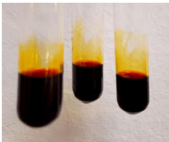
Slika 15. Uzorak za mjerenje aktivnosti, slijepa proba enzima i slijepa proba reagensa kada je kao supstrat pri mjerenju aktivnosti enzima ksilanaza korišten ksilan iz kukuruza
