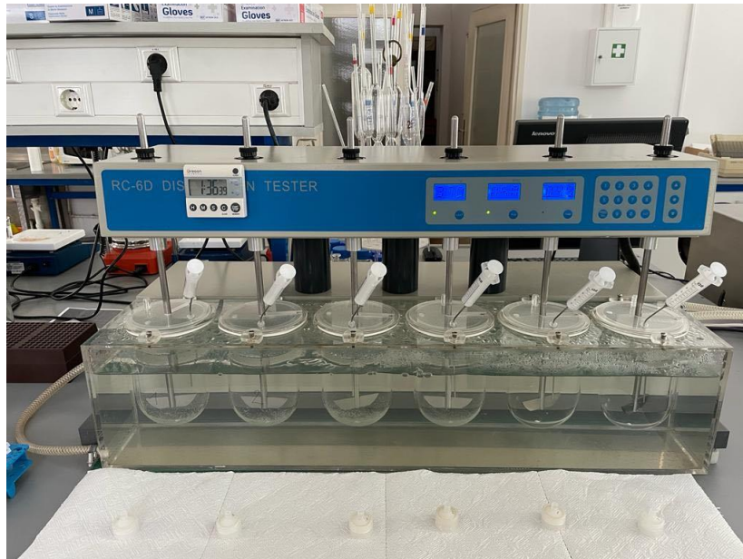
Slika 4.16. Fotografija uređaja za određivanje profila oslobađanja djelatne tvari RC-6D (Zhengzhou Nanbei Instruments, Zhengzhou, NR Kina).
