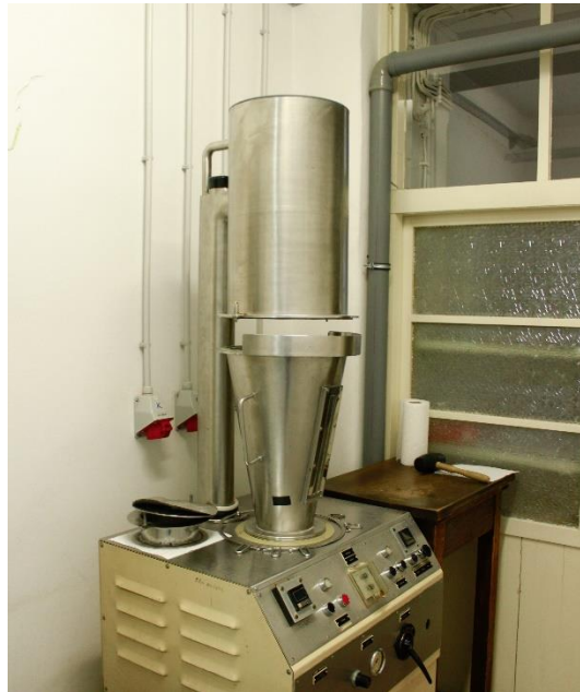
Slika 4.7. Granulator s fluidiziranim slojem Uni-Glatt (Glatt GmbH, Binzen, Njemačka)
