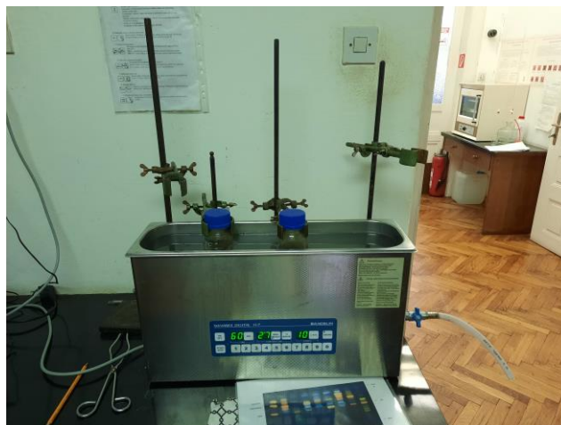
Slika 17. Ultrazvučna kupelj, Sonorex digital 10 P, Bandelin
