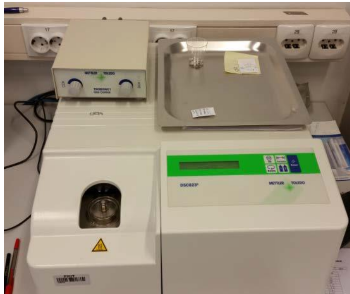
Slika 4.16. Diferencijalni pretražni kalorimetar Mettler Toledo 822° (Mettler Toledo GmbH, Greifensee, Švicarska).
