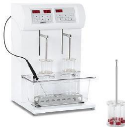
Slika 4.25. Fotografija uređaja za ispitivanje raspadljivosti tableta ZT 322 (Erweka GmbH, Langen, SR Njemačka).
