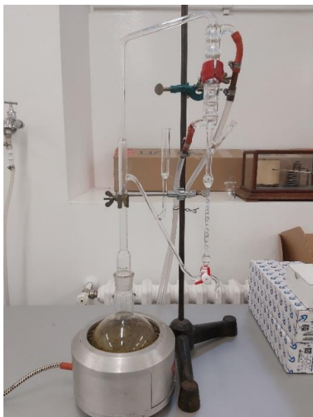
Slika 15. Aparatura za hidrodestilaciju
