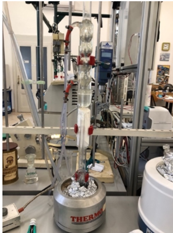
Slika 15. Provedba Soxhlet ekstrakcije kapsaicina.
