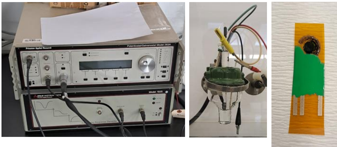
Slika 6. Prikaz aparature: potenciostat / galvanostat model 263A (lijevo), troelektrodna elektrokemijska ćelija s GC elektrodom (u sredini) i inkjet printana elektroda (desno).
