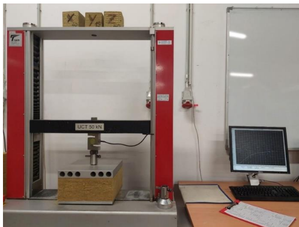
Slika 12. Uređaj Bent Tram, mjerenje tlačne čvrstoće.
