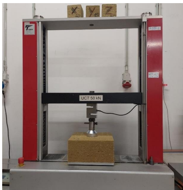
Slika 17. Uređaj Bent Tram, mjerenje točkastog opterećenja.
