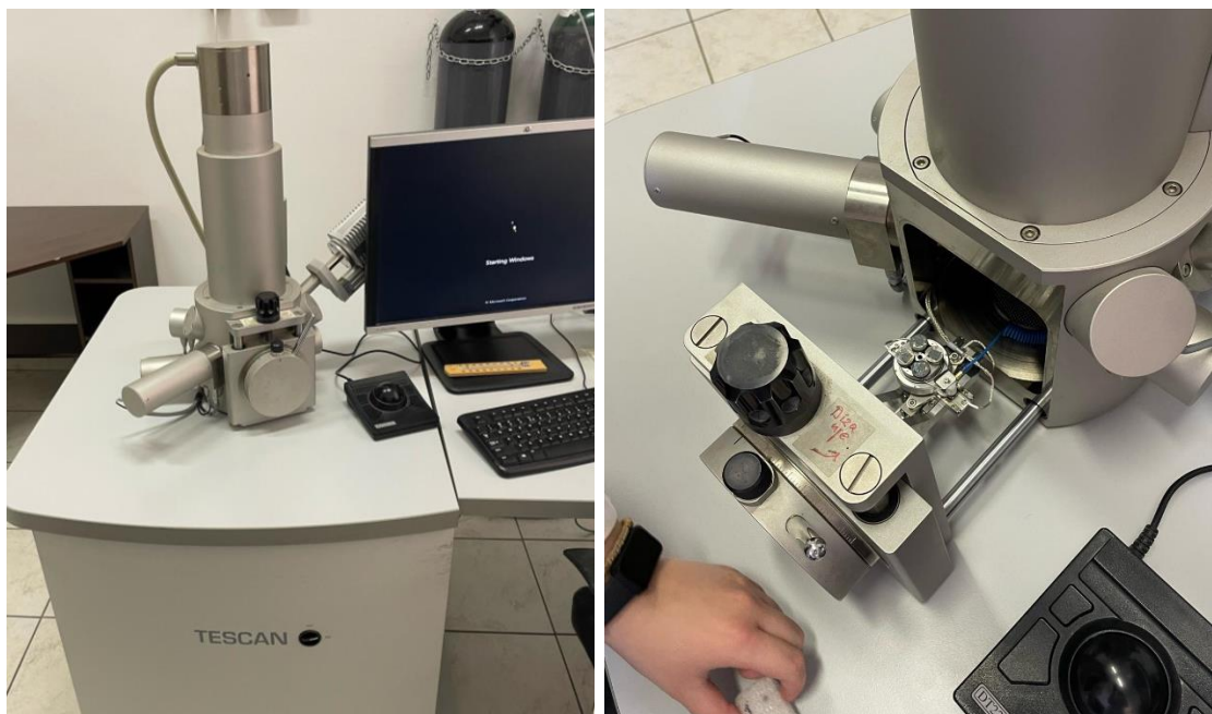
Slika 6. Tescan Vega 3 pretražni elektronski mikroskop (lijevo) i nosač uzoraka (desno)
