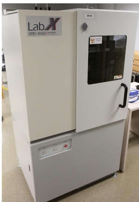
Slika 4. Shimadzu XRD 6000 difraktometar
