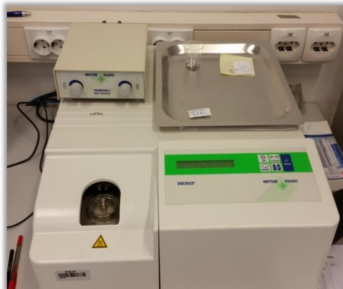
Slika 3.2. Fotografija diferencijalnog pretražnog kalorimetra (Zavod za inženjerstvo površina polimernih materijala, FKIT).
