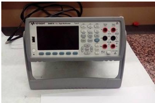
Slika3.6. Uređaj za mjerenje električnog otpora Keysight 34461 6 1/2 Digit Multimeter
