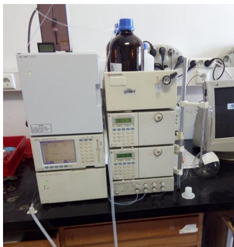
Slika 9. HPLC uređaj, Shimadzu Series 10.
