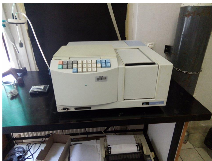
Slika 11. UV/VIS spektrofotometar, Perkin Elmer Lambda EZ 201.
