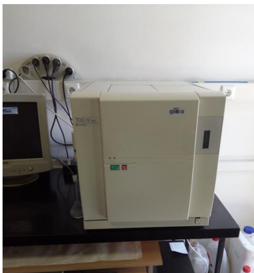
Slika 8. TOC analizator, TOC-V CPN , Shimadzu.
