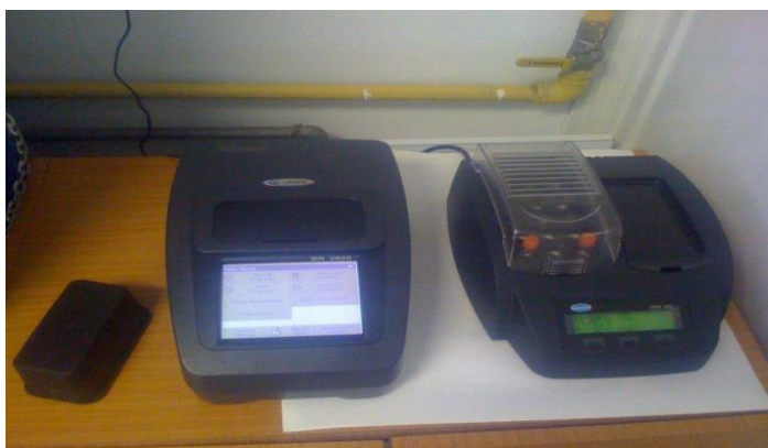
Slika 7. DR 2800 spektrofotometar i termoblok Hach Lange.
