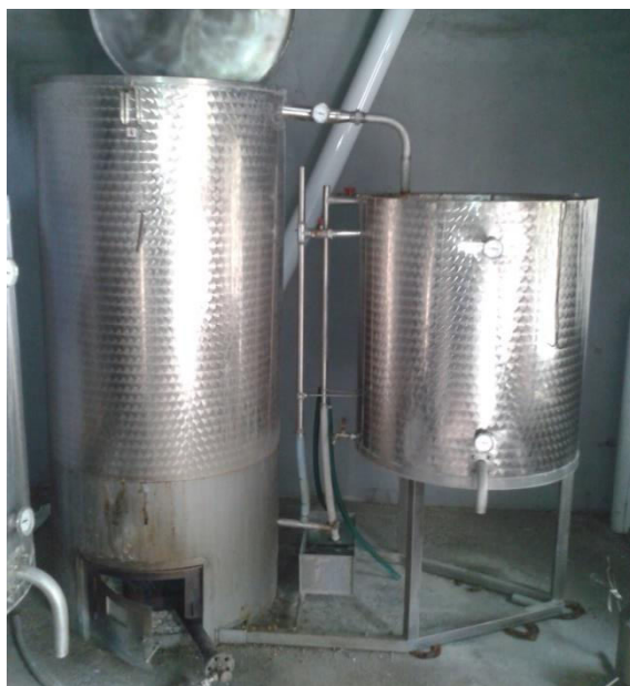
Slika 14. Šaržni destilator kapaciteta 510 L
