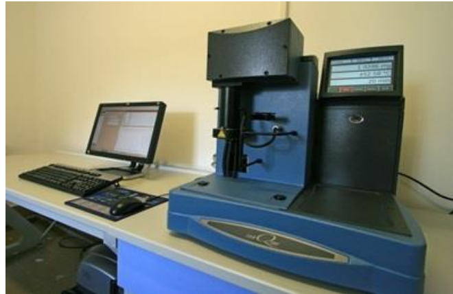
Slika 21. TGA uređaj TA Instruments Q500
