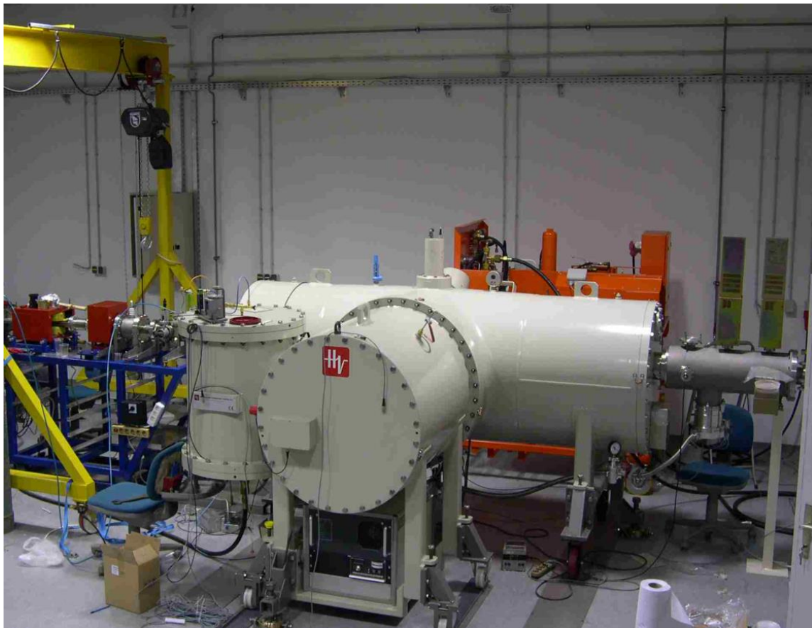
Slika 11. Akcelerator 1.0 MV Tandetron
