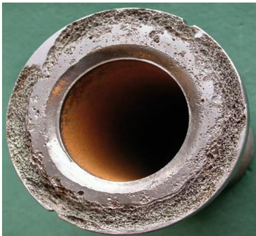
Slika 8. Prikaz korozijskog oštećenja uslijed korozije u zazoru [20] .
