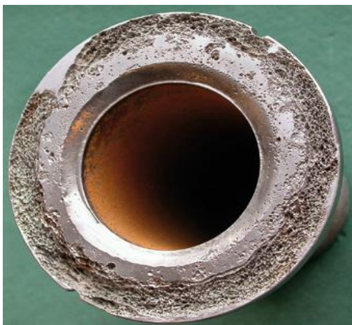
Slika 8. Prikaz korozijskog oštećenja uslijed korozije u zazoru [20] .
