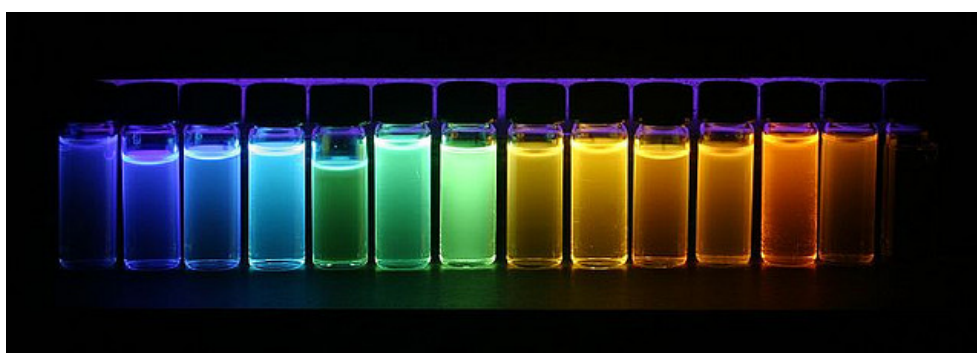
Slika 7. Isti organski spoj otopljen u otapalima različite polarnosti prilikom čega se uočava promjena boje [19].
