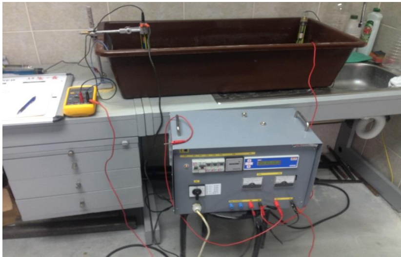
Slika 3-3. Sustav katodne zaštite pomoću napojne stanice
