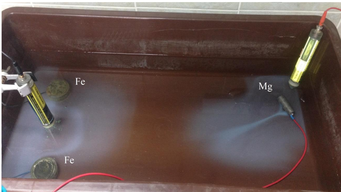
Slika 3-2. Mjerenje potencijala u sustavu katodne zaštite žrtvovanom anodom
