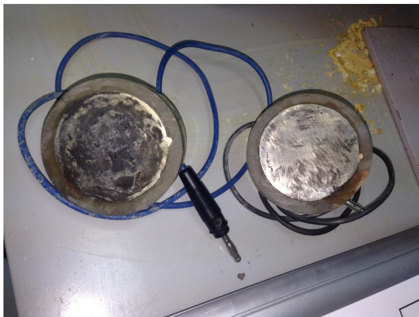
Slika 4-2. Razlika u stanju površine štice i nezaštićene Fe elektrode nakon katodne zaštite
