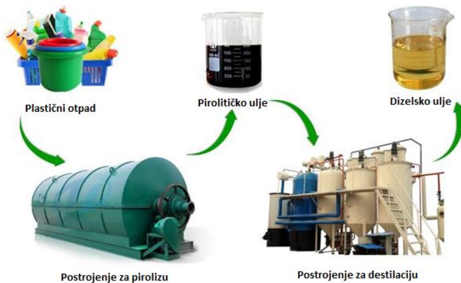
Slika 9. Proces proizvodnje dizelskog ulja iz otpadne plastike 45
