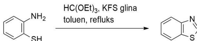
Shema 4. Sinteza benzotiazolnog prstena
