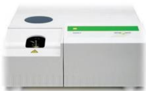
Slika 4.10. Fotografija diferencijalnog pretražnog kalorimetra Mettler Toledo 822 o (Mettler Toledo GmbH, Greifensee, Švicarska).
