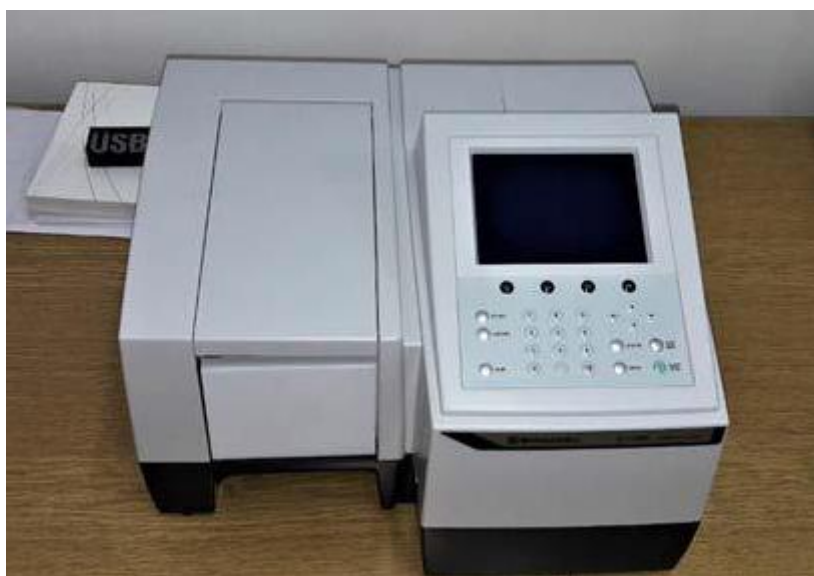
Slika 4.15. Fotografija spektrofotometra UV-1280 (Shimadzu, Kyoto, Japan).
