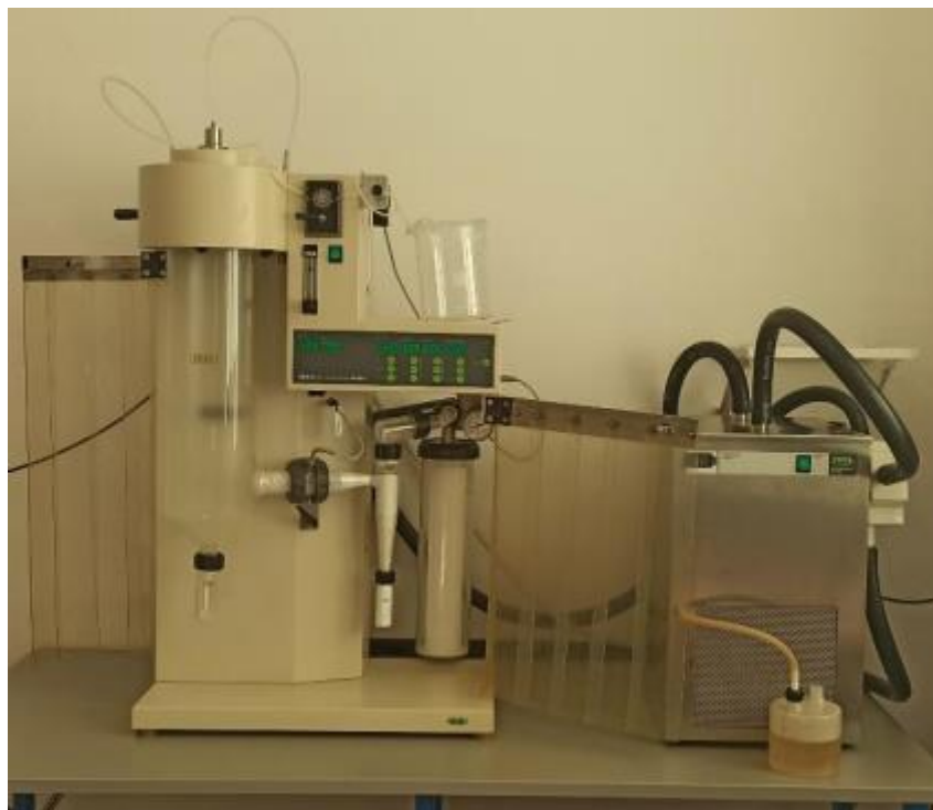
Slika 4.7. Fotografija sušionika s raspršivanjem BÜCHI Mini Spray-Dryer B-290.
