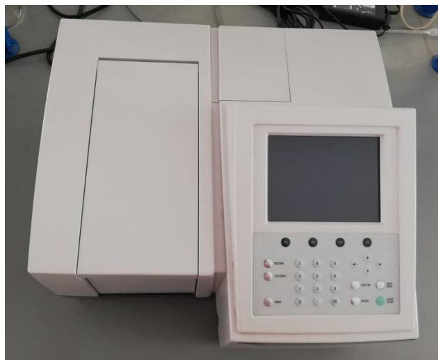
Slika 4.9. Spektrofotometar UV-1280 (Shimadzu, Kyoto, Japan)
