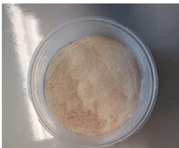
Slika 8. Punilo \text{CaCO}_3 dobiveno iz ljuske jajeta (Matančević, Diplomski rad)
