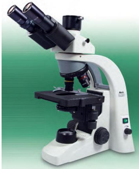
Slika 21. Svjetlosni mikroskop Motic BA200
