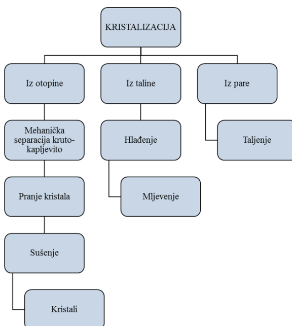
Slika 1. Načini provođenja procesa kristalizacije [6]
