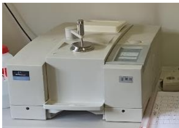
Slika 4.17. FTIR spektrofotometar Perkin Elmer Spectrum ONE s platinastim detektorom.
