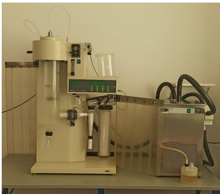
Slika 4.12. Fotografija sušionika s raspršivanjem BÜCHI Mini Spray-Dryer B-2900.
