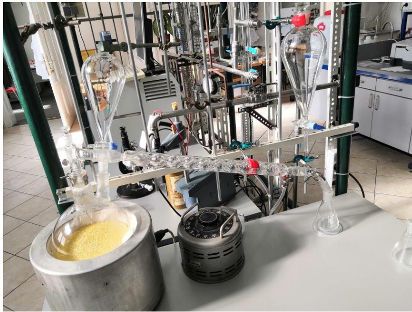
Slika 12. Aparatura za hidrodestilaciju
