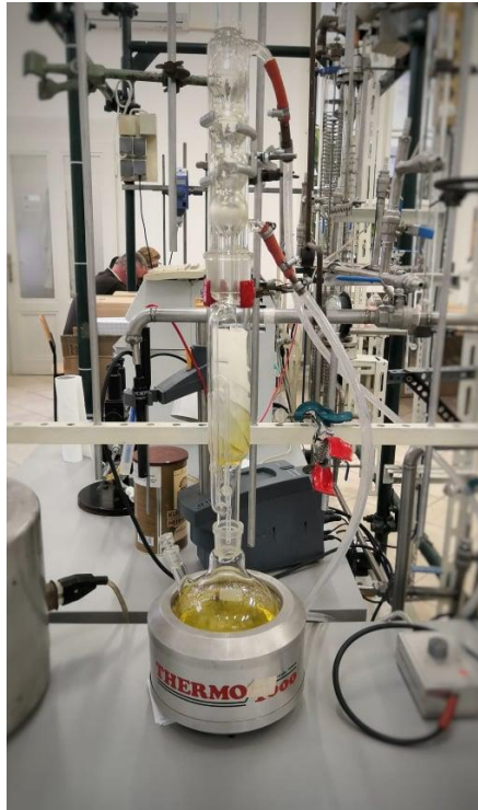
Slika 14. Prikaz Soxhletova ekstraktora
