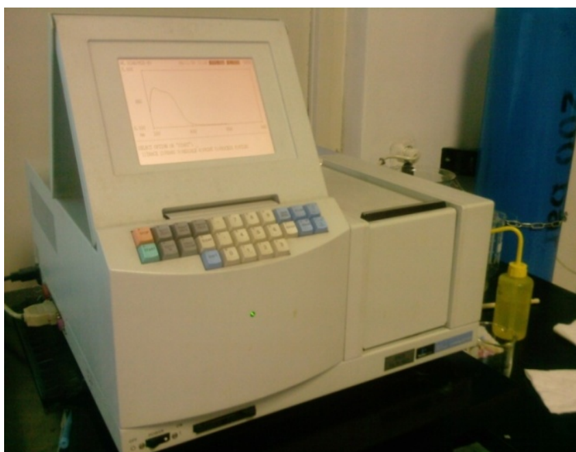
Slika 7. UV/VIS spektrofotometar, Lambda EZ 201, Perkin Elmer
