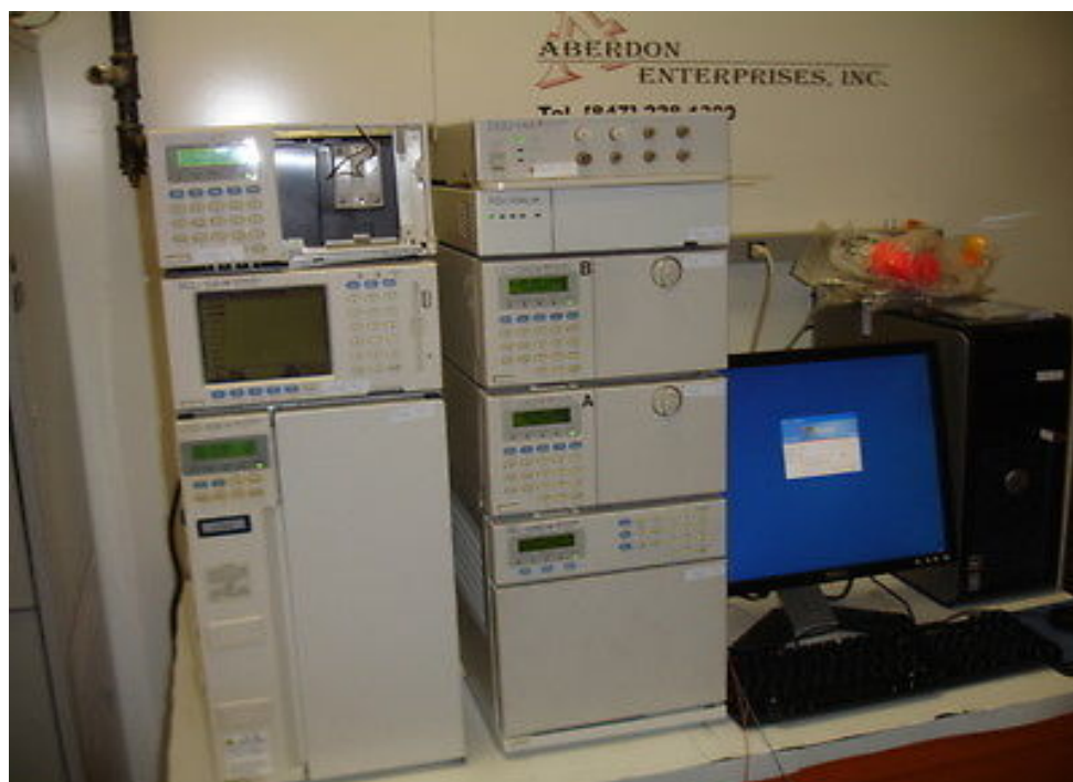
Slika 9. Tekućinski kromatograf visoke djelotvornosti, Shimadzu
