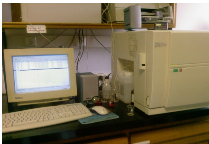
Slika 6. TOC analizator, TOC-V CPN , Shimadzu
