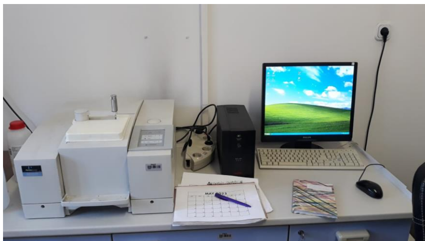
Slika 3.11. FTIR spektrometar PerkinElmer, Spectrum One
