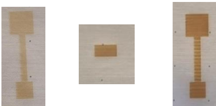
Slika 4.12. Ispisani slojevi graft kopolimera PEDOT- g -HEMA-PCL2
