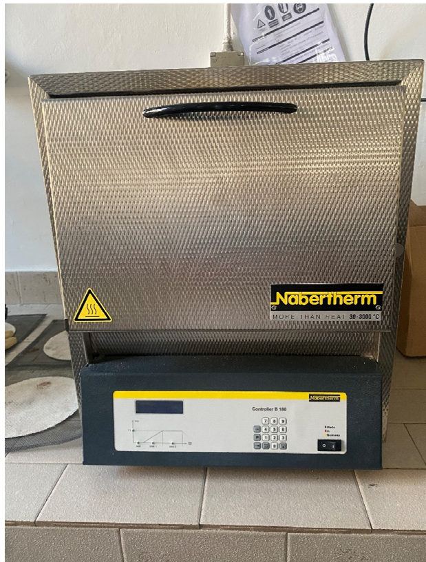
Slika 10. Peć u kojoj se provodi toplinska obrada.
