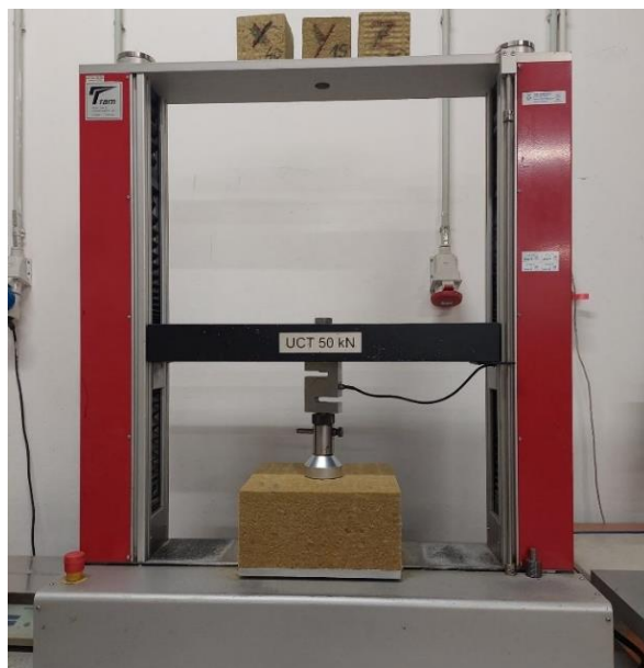
Slika 17. Uređaj Bent Tram, mjerenje točkastog opterećenja.
