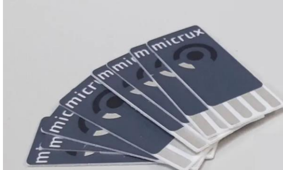
Slika 11. Plošna tiskana ugljikova elektroda ED-S1PE-C2, Micrux Fluidic.
