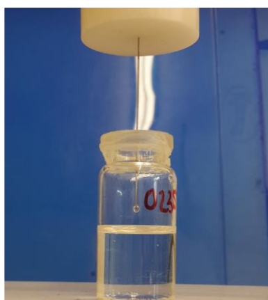
Slika 12. Prikaz mikroekstrakcije jednom kapi
