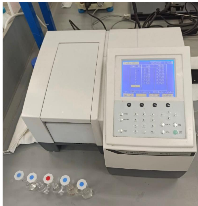
Slika 5. Fotografija UV/Vis spektrofotometra UV-1280 (Shimadzu, Kyoto, Japan)
