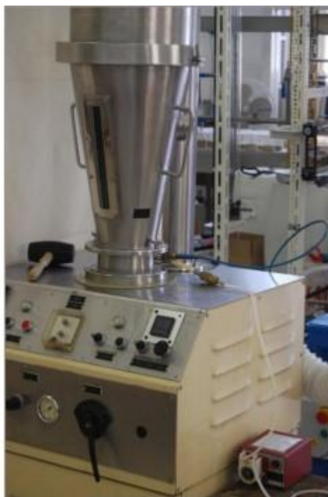
Slika 2. Fotografija granulatora s fluidiziranim slojem Uni-Glatt (Glatt GmbH, Binzen, SR Njemačka)
