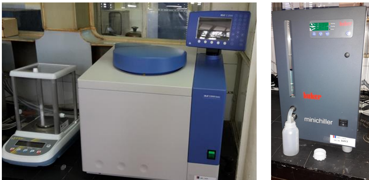
Slika 3.8. Kalorimetar- IKA Werke Gmbh&Co.KG- C 2000 control i sustav za hlađenje kalorimetra- Huber minichiller
