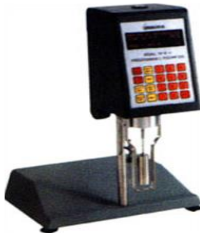
Slika 3.6. Rotacijski viskozimetar Brookfield DV – III ULTRA
