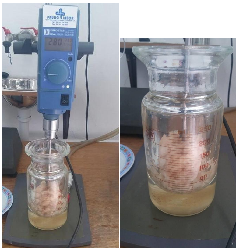
Slika 21. Otapanje masnoća u reaktoru uz miješanje
