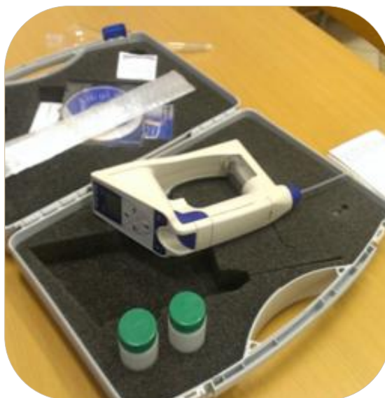
Slika 29. Uređaj za mjerenje gustoće
