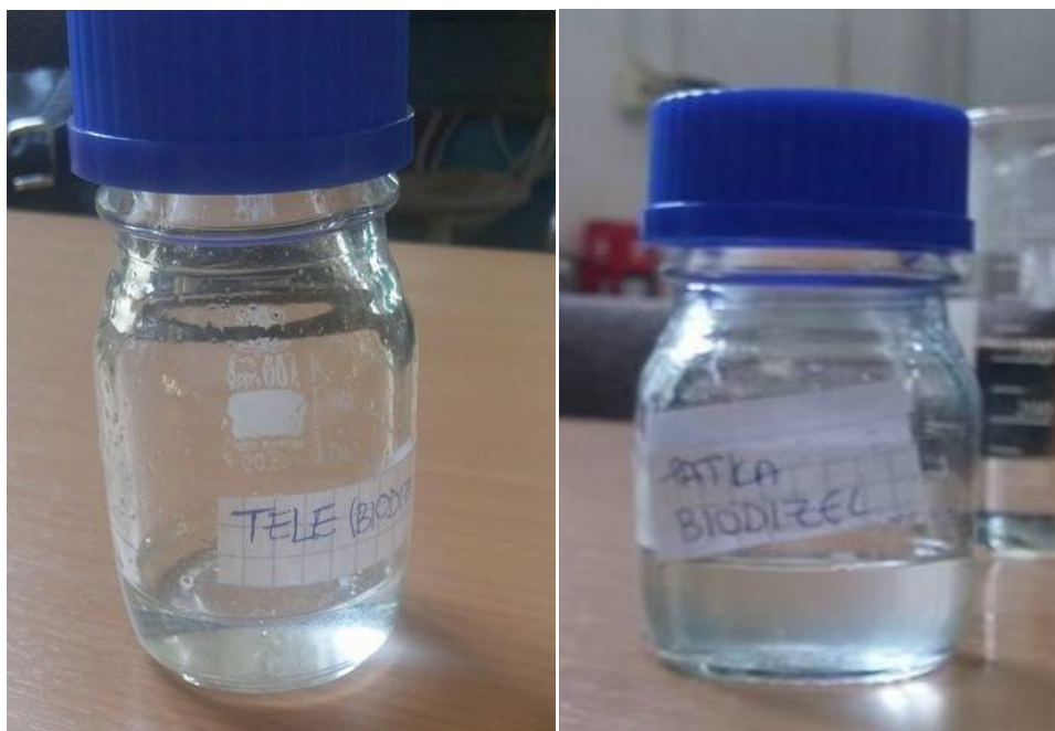
Slika 26. Sirovi biodizel sintetiziran iz telećeg loja i pačje masti
