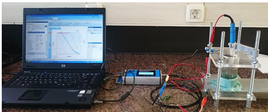
Slika 16. Aparatura korištena za ispitivanje svojstava premaza u velikoj ćeliji
