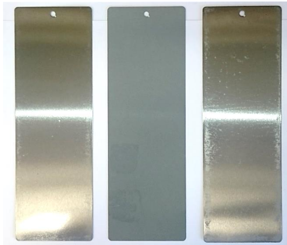
Slika 17. Uzorci ispitivani u slanoj komori
