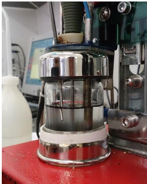
Slika 17. Reaktorska posuda s modelnom otopinom i otopljenom PAT
