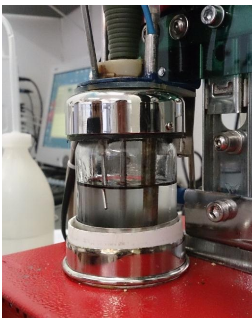
Slika 17. Reaktorska posuda s modelnom otopinom i otopljenom PAT
