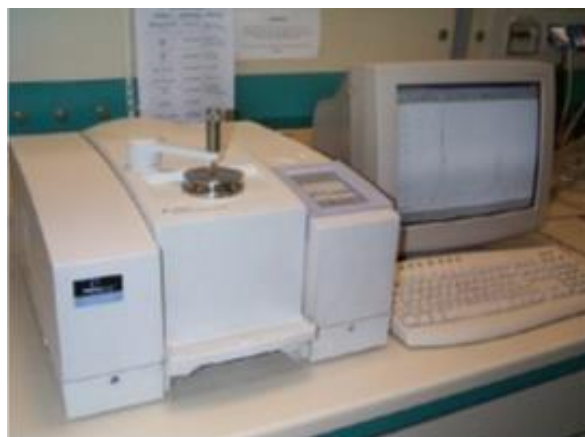
Slika 14. Perkin Elmer, Spectrum One FTIR spektrometar
