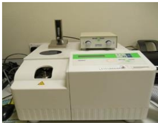
Slika 16. DSC analizator Mettler Toledo 822e
