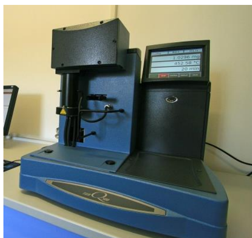
Slika 17. Termogravimetar, Q500, TA Instruments
