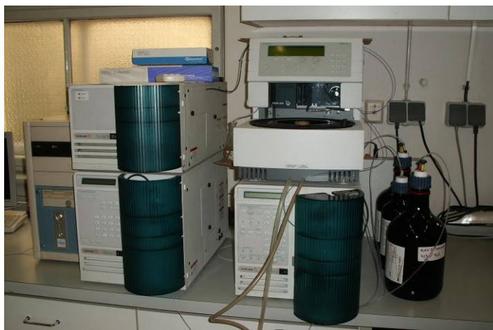
Slika 7. Tekućinski kromatograf visoke djelotvornosti, s detektorom s nizom dioda (HPLC-DAD)
