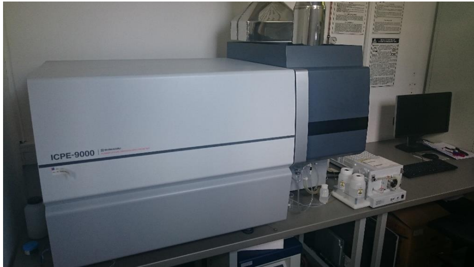
Slika 8. ICP-OES za analizu elemenata u tragovima
